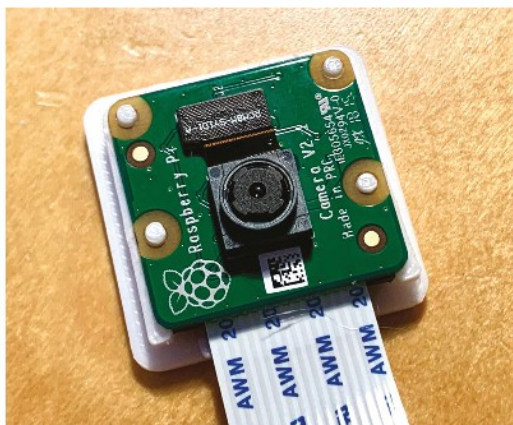
▲ Il Raspberry Pi Camera Module ufficiale è la scelta perfetta per questo progetto
